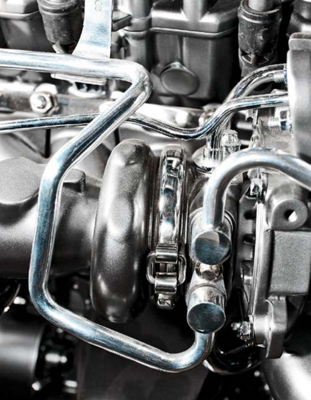
— VPP-Profilschelle zur Anwendung im Turbolader eines Hybridfahrzeugs
