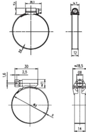
Les colliers bande ajourée BA14 sont conformes à la norme NF E 27 851 certifié par l'AFNOR. Ces colliers sont d'une largeur de bande de 14 mm, leur fabrication fait l'objet de contrôle très strict au niveau de la matière, vis et traitement de surface. Ils sont livrés tête et bande séparées pour une plus grande facilité de stockage et de montage. Ils se posent rapidement grâce à leur système d'attache permettant à la bande de venir se fixer à la base du capot.
